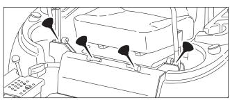
Figure 23. Control Handle Pivots & Seat Pivots
